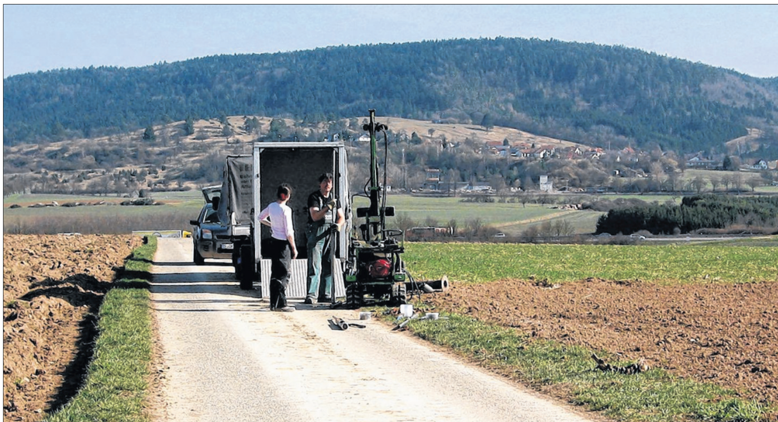
BLICK IN DIE TIEFE: Die Daimler AG hat mit Rammkernsondierungen auf der Mühlbachebene begonnen. Der Konzern will herauszufinden, ob der Untergrund überhaupt geeignet ist, um darauf eine Teststrecke samt Prüfzentrum zu errichten. Privatbild
